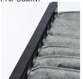
La conception de la poche conique sur toute la longueur minimise le contact entre les poches, ce qui maximise l'utilisation des supports et garantit une faible résistance au flux d'air.
